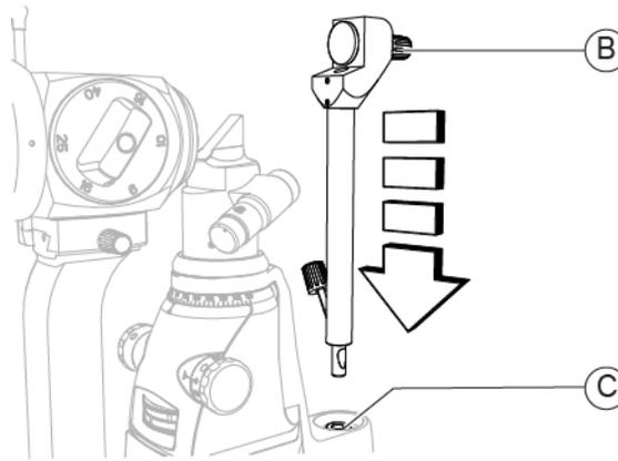
Fig. 75 - Insert the calibration rod
