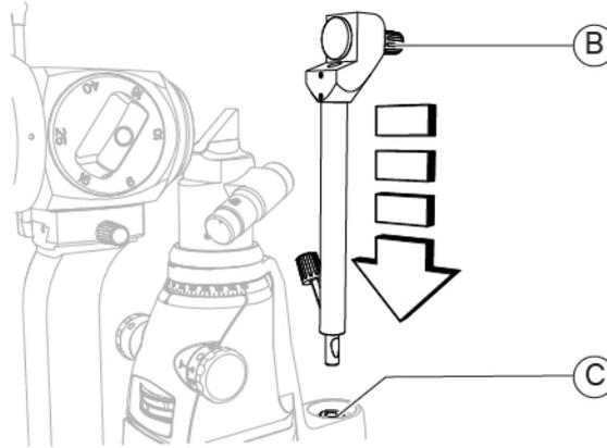
Fig. 131 - Insert the calibration rod
