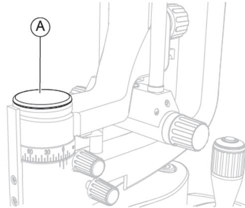
Fig. 163 - Insert the cap
