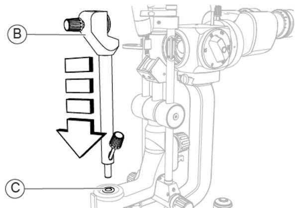
Fig. 88 - Insert the calibration rod
