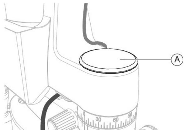
Fig. 146 - Insert the cap
