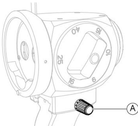
Fig. 124 - Loosen the knob
