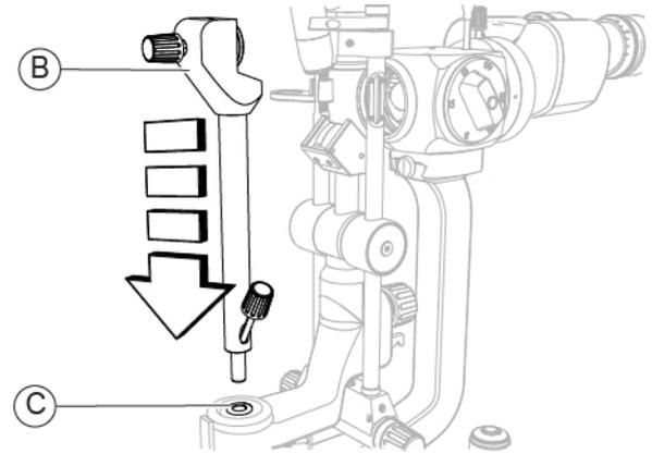
Fig. 149 - Insert the calibration rod
