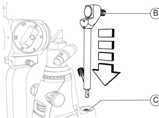
Fig. 57 - Insert the calibration rod
