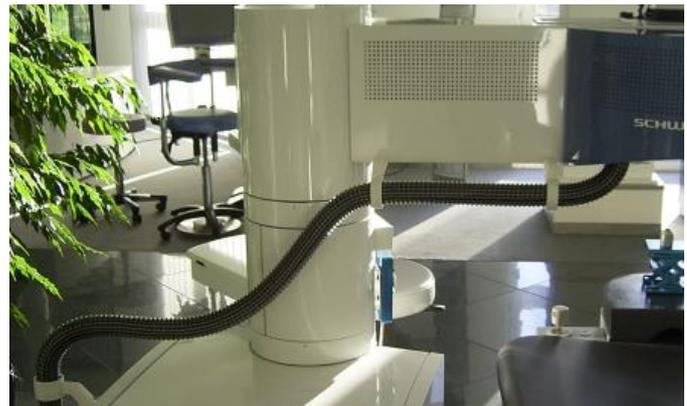
Abbildung 4-8: Externe Absaugereinheit mit Filter und Verrohrung und mit Verbindung zur Absaug-Düse
