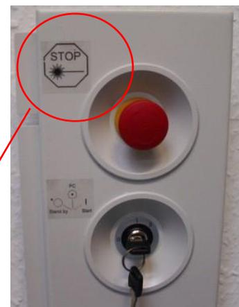
Schalten Sie anschließend den AMARIS mit dem Schlüsselschalter aus (**Standby-Position**) bzw. ein (**Start-Position**).
