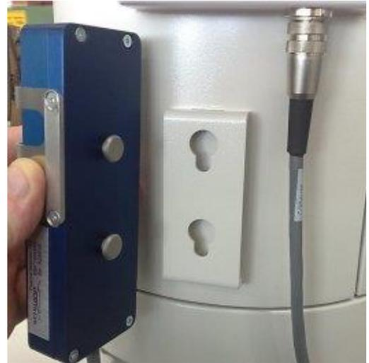
**Abbildung 7-16: Halterung für den Fluence-Detektor**
