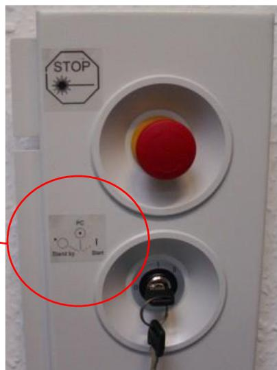
Abbildung 6-7: Schlüsselschalter
