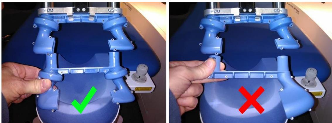
Abbildung 10-1: Austausch der Zwei-Kanal-Düse
