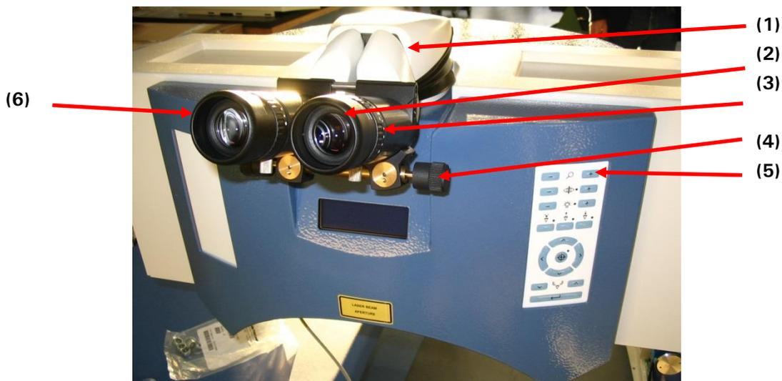
**Abbildung 6-10: Komponenten des Operationsmikroskops (Beispiel AMARIS 750S)**
