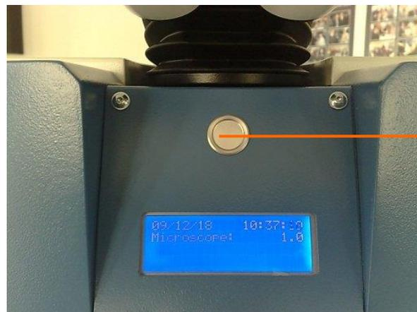
Drücken Sie die Taste mindestens **0,5 Sekunden** lang, um den Kreuzlaser EIN oder AUS zu schalten.
