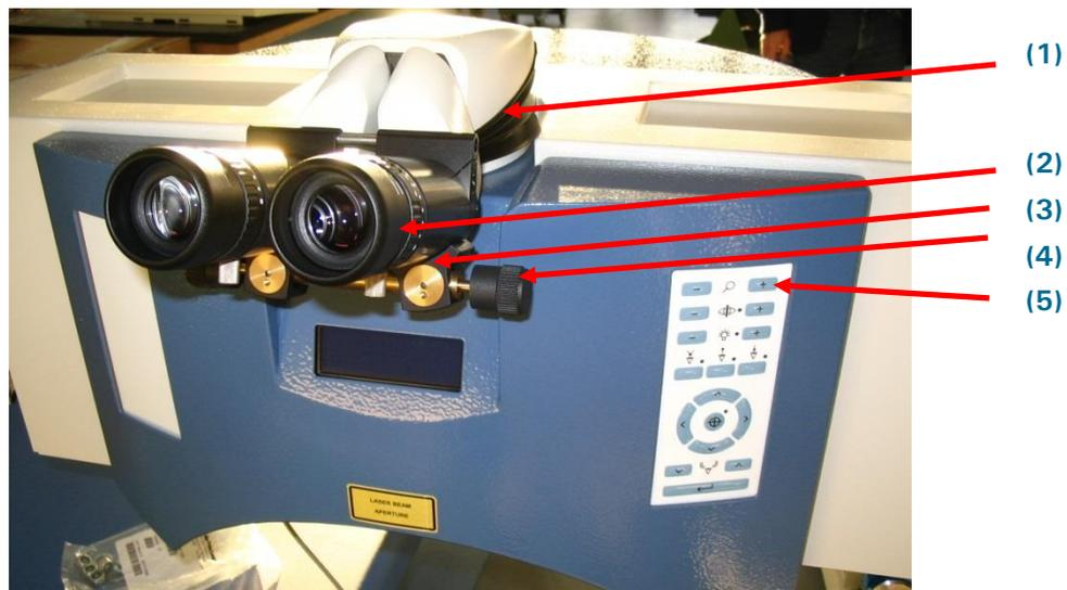
Abbildung 4-4: Komponenten des Operationsmikroskops (Beispiel AMARIS 750S)
