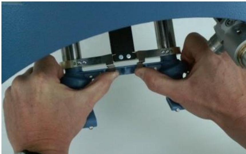
**Abbildung 10-4: Wechseln der Düse**
