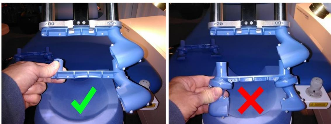
Abbildung 10-5: Austausch der Ein-Kanal-Düse
