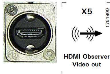
**Abbildung 4-17: HDMI-Buchse an der Anschlussplatte**
