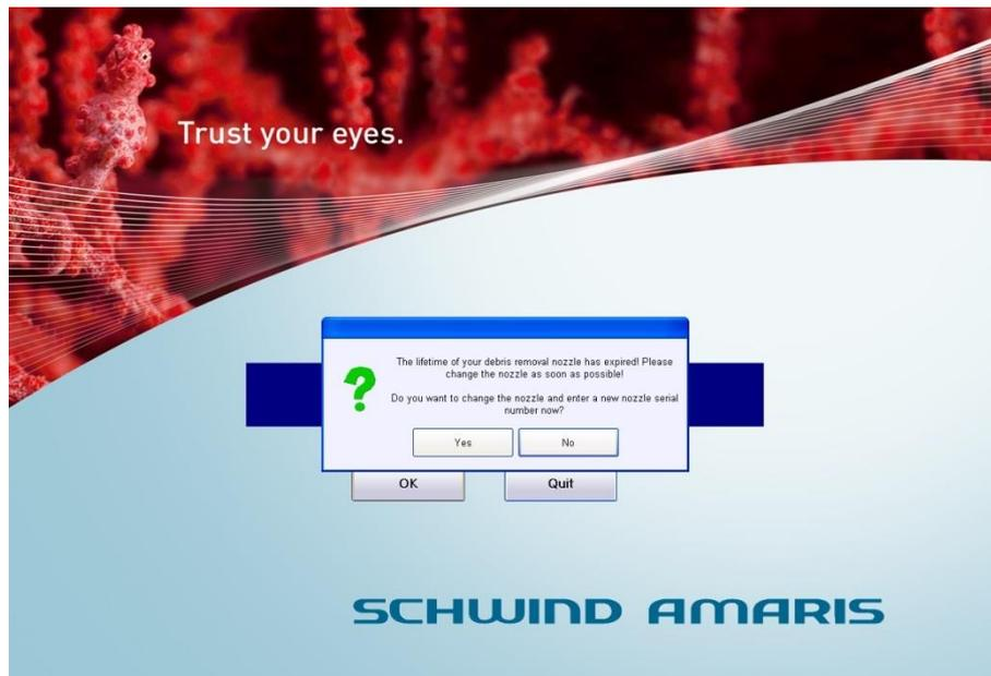
**Abbildung 10-2: Aufforderung zum Wechseln der Düse für die Partikelabsaugung**
