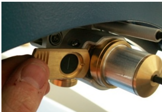
Figura 4-13: Sostituzione dei moduli di apertura
