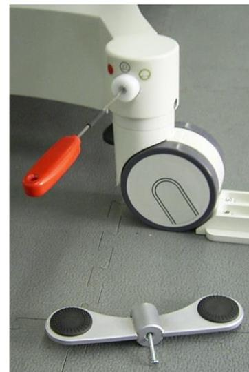
Die Richtungswahl der Räder (Radrichtung) ist blockiert, wenn sich der Hebel in der heruntergedrückten **GRÜNEN** Position befindet; die Räder werden in der Schwenkrichtung blockiert (siehe **Abb. C**). In der Schwenkrichtung muß die Radrichtung arretiert sein.
