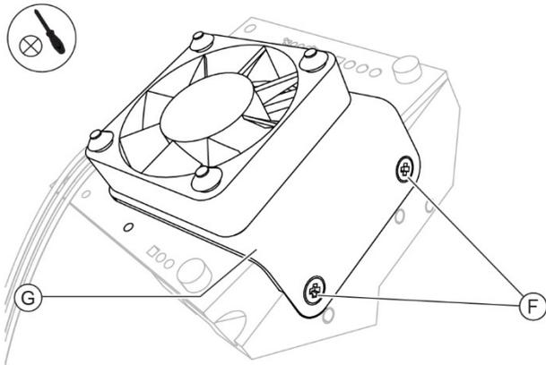
Fig. 109 - Place the cooling fan
