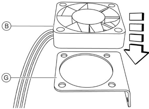
Fig. 107 - Place the cooling fan
