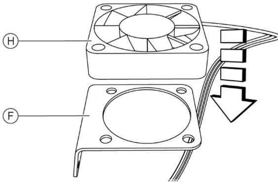
Fig. 117 - Place the cooling fan
