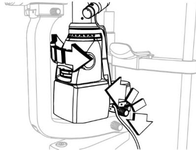
Abb. 53 - Einstellen des Projektionswinkels der Beleuchtungseinheit
