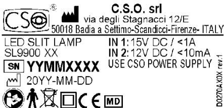
Abb. 5 - Typenschild für das Modell Xx
