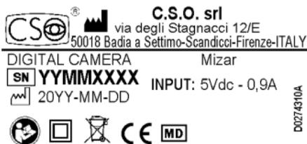
Fig. 8 - Plaque signalétique de la caméra, dispositifs version Xx-D
