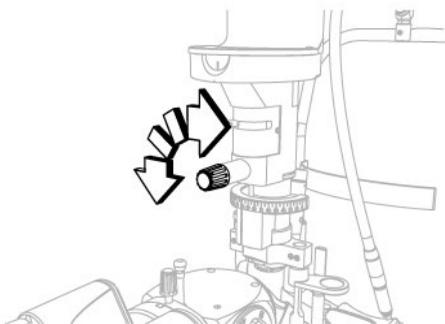
Fig. 64 - Régler la hauteur de la fente
