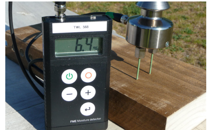
STIFTFÖRMIGES FEUCHTEMESSGERÄT (PIN-METER)
