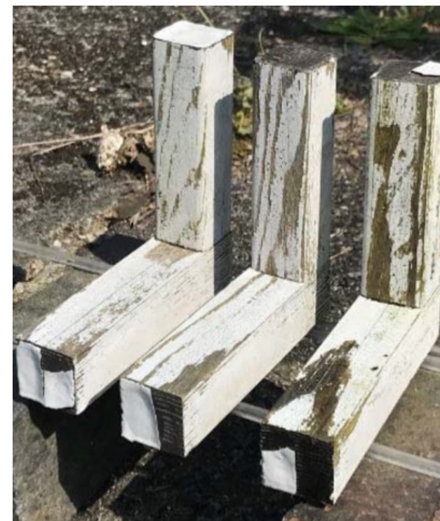
Die acetylierten L-Verbindungen nach 20 Jahren Exposition
